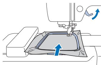
**3** Надежно вставьте направляющую пялец в держатель рамы каретки вышивального модуля.
