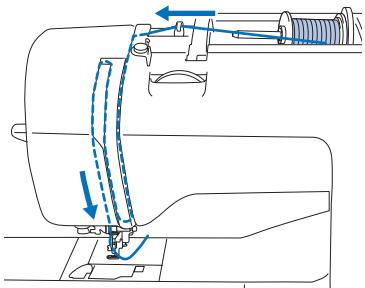
→ При заправке верхней нити строго следуйте инструкциям.
