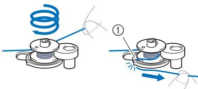
(1) Направляющая прорезь в седле устройства намотки шпульки (со встроенным устройством обрезки нити)
