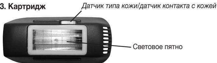
В *картридже* прибора beurer SalonPro System имеется встроенный *датчик типа кожи*.
