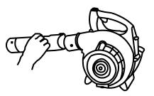
ВРАЩАЮЩЕМ ДВИЖЕНИЕМ ВСТАВЬТЕ СОБРАННУЮ ВЫ-ПУСКНУЮ ТРУБУ В ИНСТРУМЕНТ
