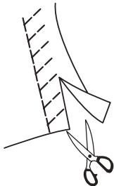
Установите ткань таким образом, чтобы оставался припуск в 5/8" (1,5 см). Обрежьте припуск близко к стежкам. Будьте осторожны, чтобы не разрезать стежки.
