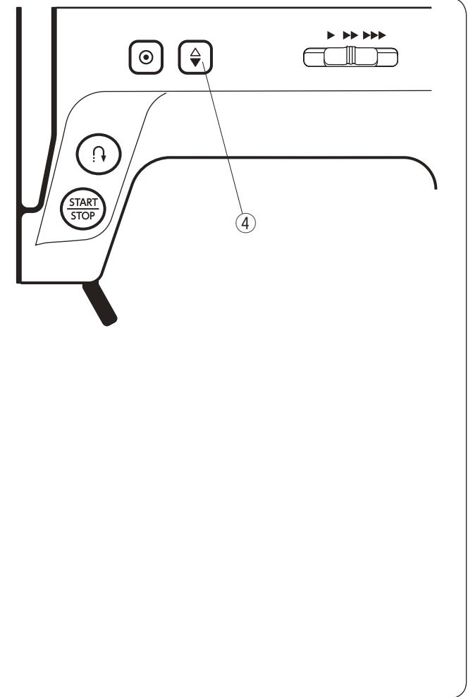
**④ Кнопка подъёма/опускания иглы**
